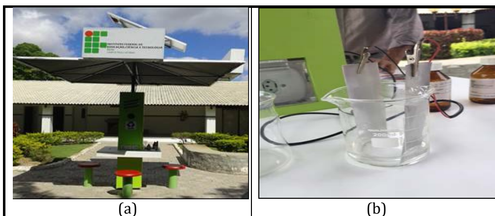
Figura 1. a) Protótipo sistema fotovoltaico; b) Montagem do reator eletroquímico para eletrofloculação da água de lavagem do biodiesel.
