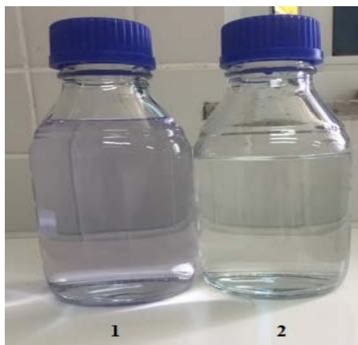
Figura 9. Efluente têxtil. (1) Antes da eletrofloculação; (2) Após a eletrofloculação.
