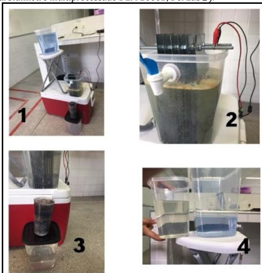
Figura 5. Purificação de efluente têxtil a fluxo contínuo. (1) montagem do reator de eletrofloculação em fluxo contínuo, (2) reator de eletrofloculação, (3) filtro de leito fixo, e (4) comparação do efluente bruto e tratado.
