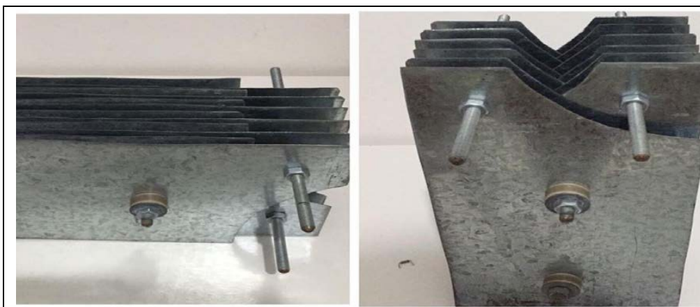
Figura 4. Arranjo de placas monopolares conectadas em paralelo.
